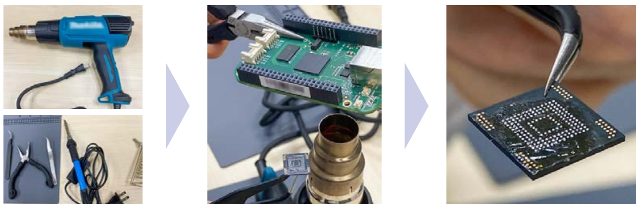
図6 ECUの基板よりチップを取り出す様子
