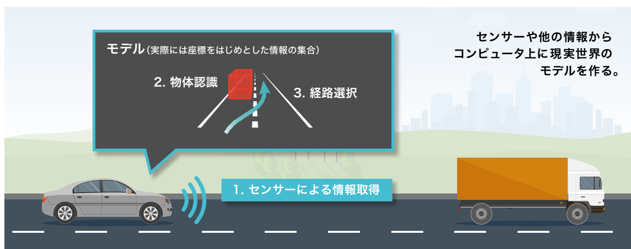
図8 前方にクルマがある場合の自動運転中のクルマの制御
