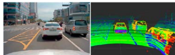
図5 センシングの結果(左:車載カメラ、右:LiDAR)
