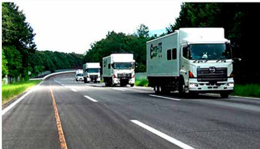
図 -2 トラックの隊列実験 ( http://clicccar.com/2014/06/19/258966/ より)
