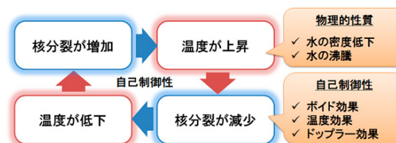
図5 原子炉の核反応自己制御性
